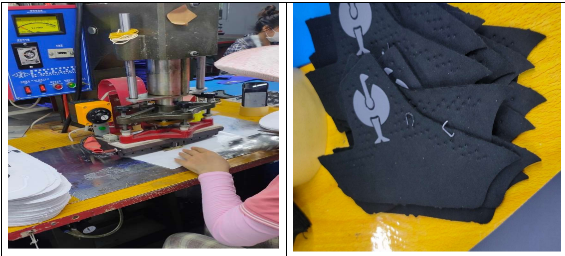
Hình 1.5. Máy dập và sản phẩm sau khi dập logo
