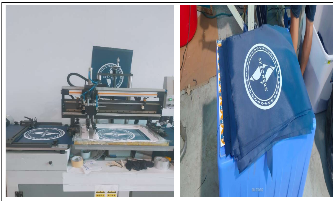
Hình 1.4. Máy in lưới tự động và sản phẩm sau in
